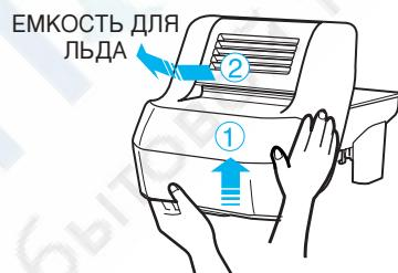
**Как установить ее на место:** Устанавливая емкость для льда, сильно нажмите на нее, чтобы она встала на место. Если она не вставляется полностью, выньте ее и поверните механизм привода на 1/4 оборота. Затем вновь попытайтесь установить емкость на место, нажав на нее.
